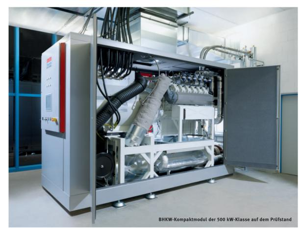
Herzstück des BHKW ist ein Gasmotor, der einen Stromgenerator antreibt. Die Kühlwasser- und Abgaswärme wird über ein System von Wärmetauschern ausgekoppelt und an Heizungswasser übertragen. Motor, Generator und Grundrahmen sind mehrfach schwingungsgedämpft gelagert, das Gehäuse mit integrierter Schaltanlage ist komplett schallisoliert.
